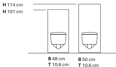
← Das Sanitärmodul Geberit Monolith ist in zwei Bauhöhen erhältlich.
